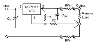
Figure 23. Load Sensing
